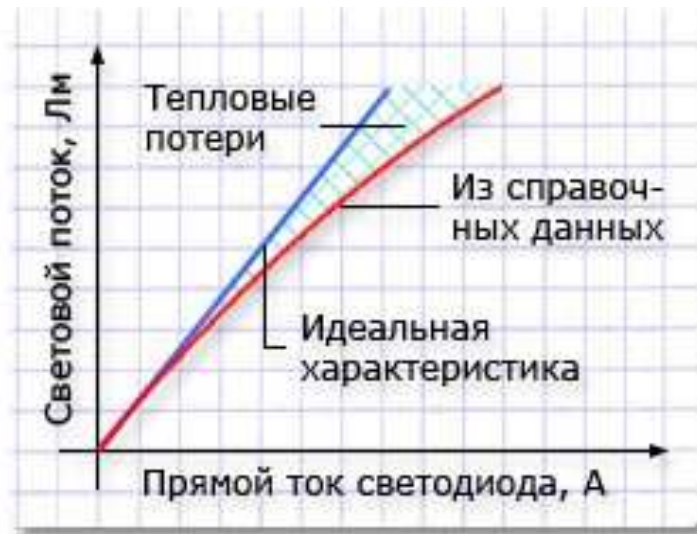
Рис. 7.7. Зависимость светового потока от тока светодиода
