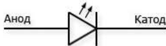
Рис. 7.4. Обозначение светодиода в электрических схемах
