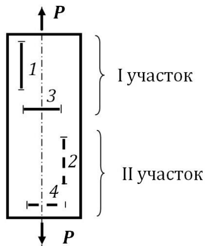
Рисунок 2.1.4 – Схема расположения исследуемых участков образца и тензометров на образце: 1, 2 – продольные тензометры; 3, 4 – поперечные тензометры (пунктиром показаны тензометры на невидимой грани образца)
