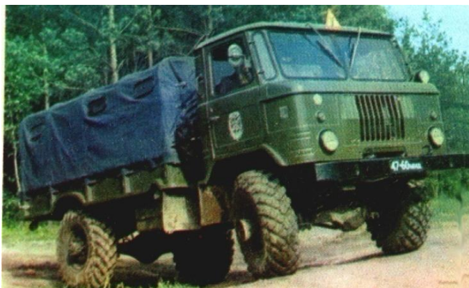
Рис. 13.62. Полноприводный автомобиль ГАЗ-66
