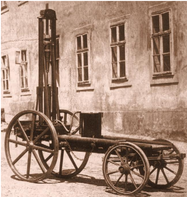
Рис. 7.8. Повозка Маркуса с атмосферным двигателем, 1870 г. (Австро-Венгрия)
