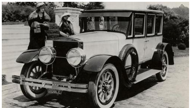
Рис. 5.41. Паровой автомобиль с закрытым кузовом «Добль Детройт, Модель С», 1916 г.
