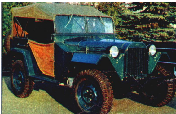
Рис. 13.30. Полноприводный автомобиль ГАЗ-67Б
