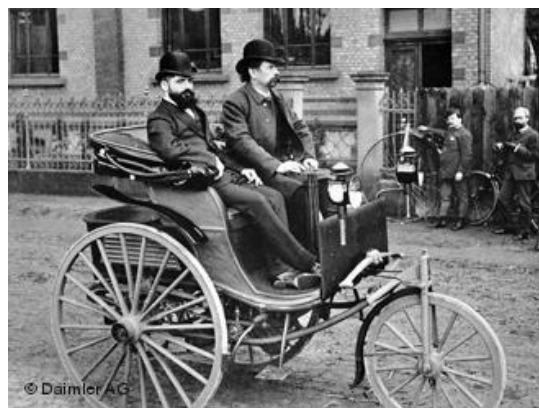
Рис. 7.21. Автомобиль Бенц с подвеской кузова на эллиптических рессорах, 1889 г. (Германия)
