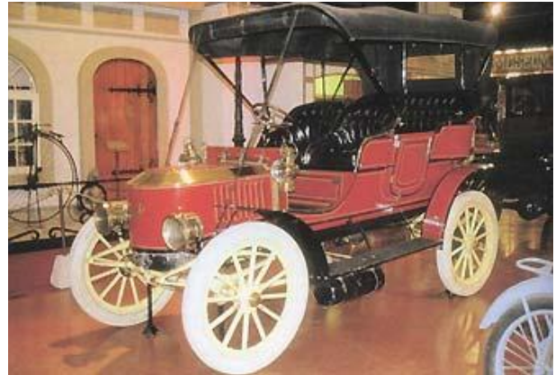
Рис. 5.34. Паровой автомобиль Стенли капотной компоновки, 1903 г.
