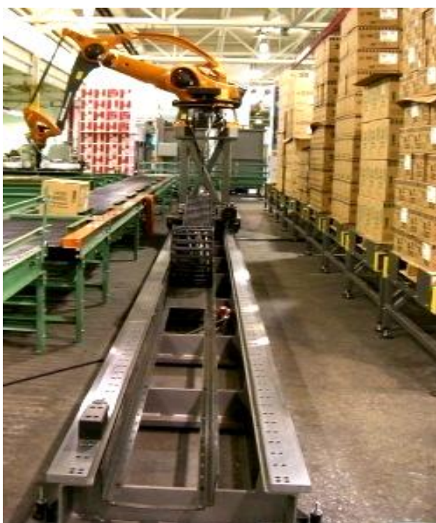
Рис. 1.8 Робот KUKA на продольной оси Güdel (Германия)
