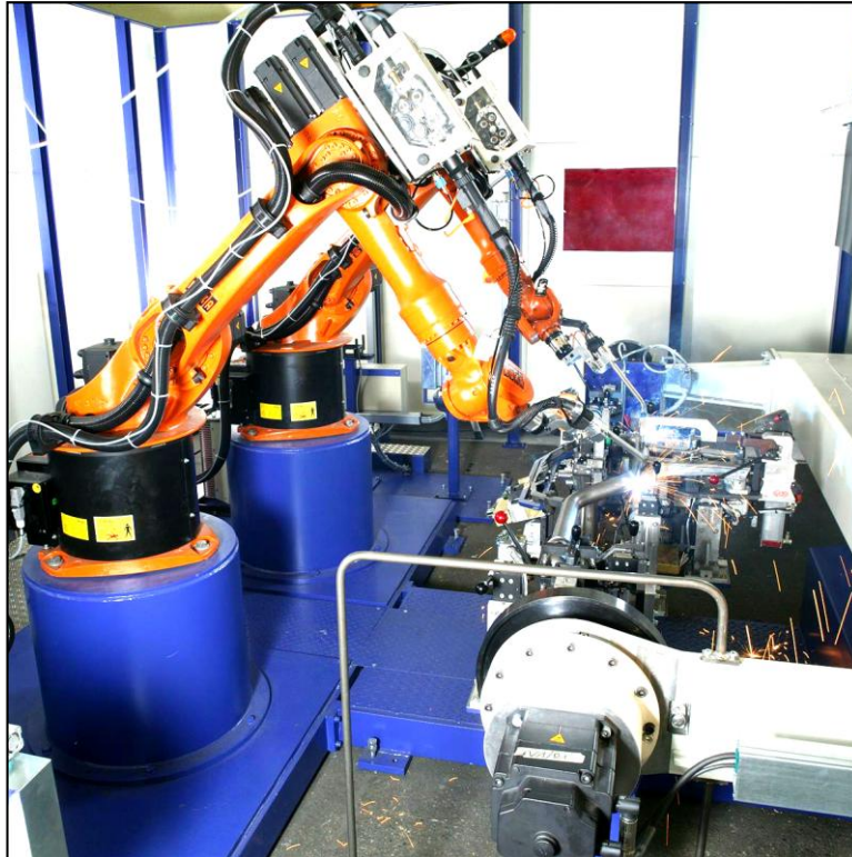
Рис. 8.24 Сварочный РТК в составе двух роботов фирмы KUKA (Германия) и координатного стола
