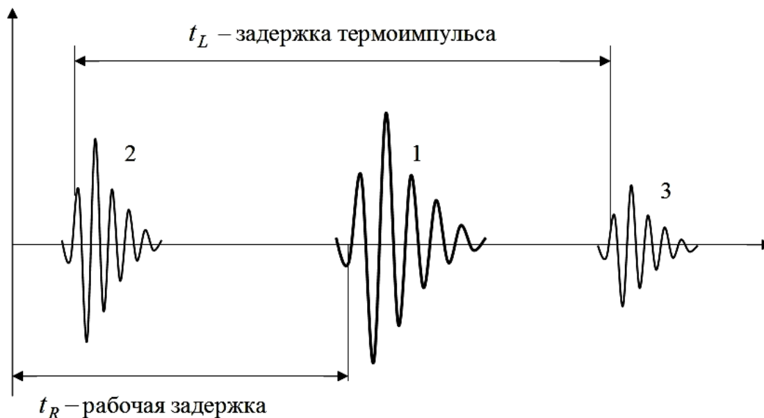
Рис. 9.23. Типичная осциллограмма импульсов: 1 – рабочий импульс релеевской волны; 2 – первый отраженный термоимпульс; 3 – второй отраженный термоимпульс
