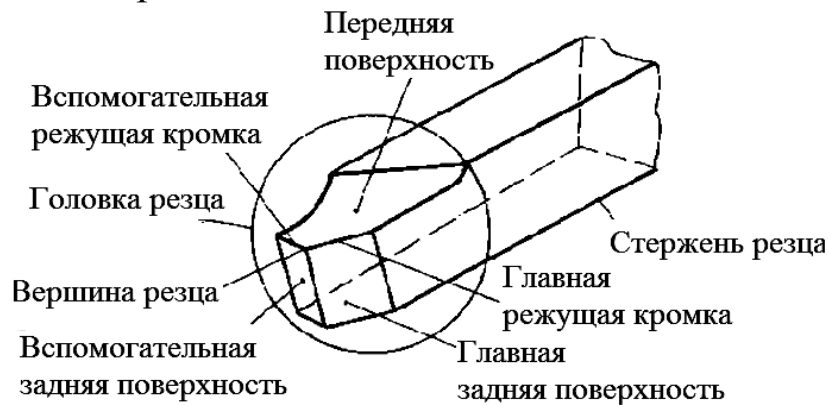
Рис. 85. Элементы резца
