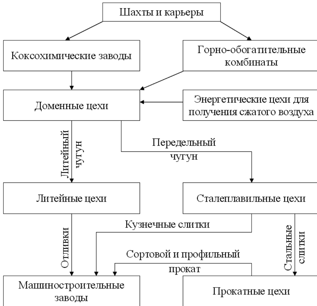
Рис. 1. Схема металлургического производства
