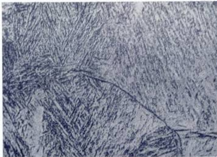
Рис. 5.9. Участок перегрева, околошовная зона (сталь 35Х3Н3М)
