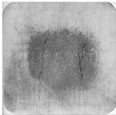
Рис. 4.6. Грубые внутренние разрывы, возникшие при деформации вследствие осевого перегрева стали 37X12H8Г8МФБ
