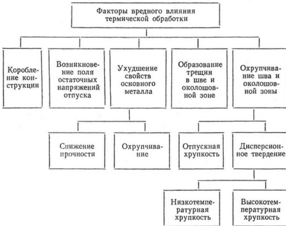
Рис. 2.4. Возможные отрицательные последствия термической обработки по В. Н. Земзину, Р. З. Шрону [8]
