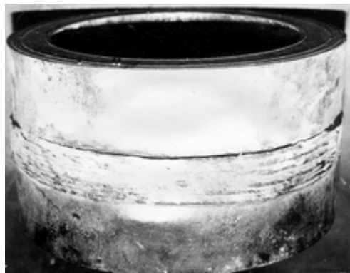
Рис. 6.6. Общий вид разрушенного сварного соединения
