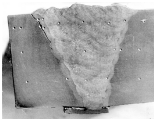
Рис. 6.7. Характер развития трещины
