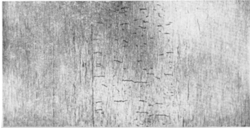
Рис. 4.8. Флокены в продольном макрошлифе
