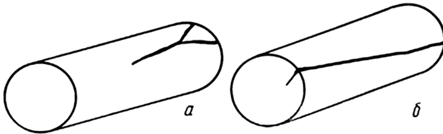
Рис. 4.10. Схематическое изображение раскатанной горячей трещины на деформированном прутке: а – продольная трещина; б – продольная или косая трещина
