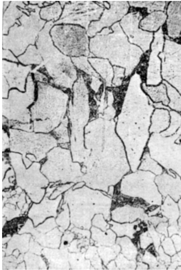
Рис. 6.2. Структура металла шва после перегрева выше температуры A_{C_3} , \times 100
