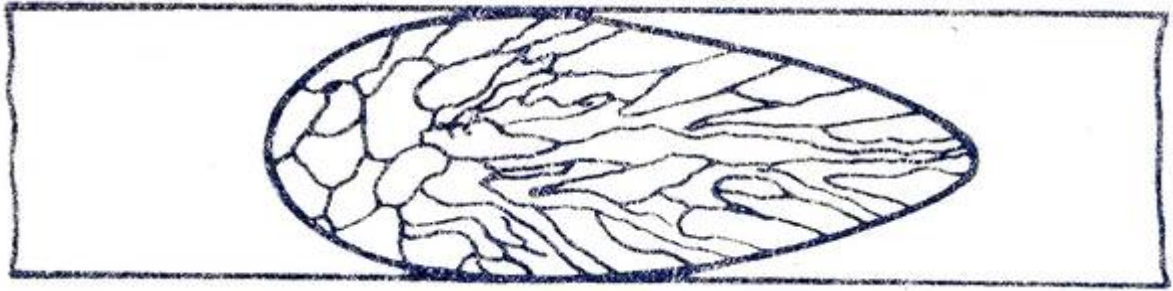
Рис. 1.11. Кристаллическое строение сварочной ванны при мгновенном прекращении сварки
