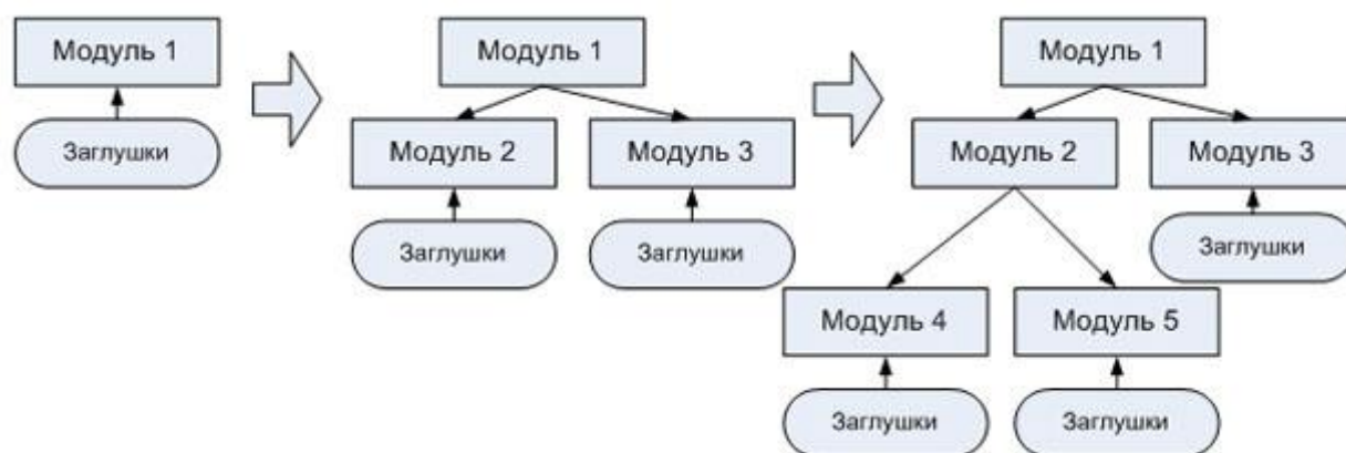
Рис. 2. Постепенная интеграция модулей при нисходящем методе тестирования
