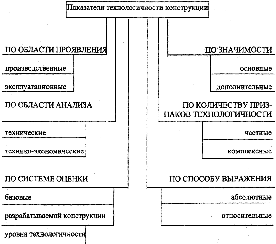
Рис. 4.2. Классификация показателей технологичности конструкции изделия
