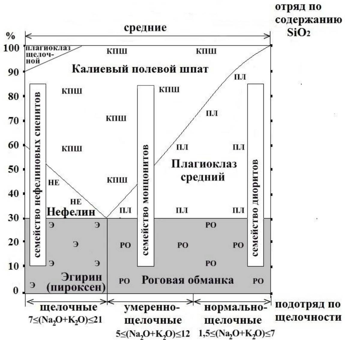
Рис. 6. Диаграмма количественно-минералогического состава пород с 30 %-ным содержанием тёмноокрашенных минералов. Поле тёмноокрашенных минералов закрашено серым цветом. Прямоугольные окна соответствуют процентному соотношению минералов в семействах
