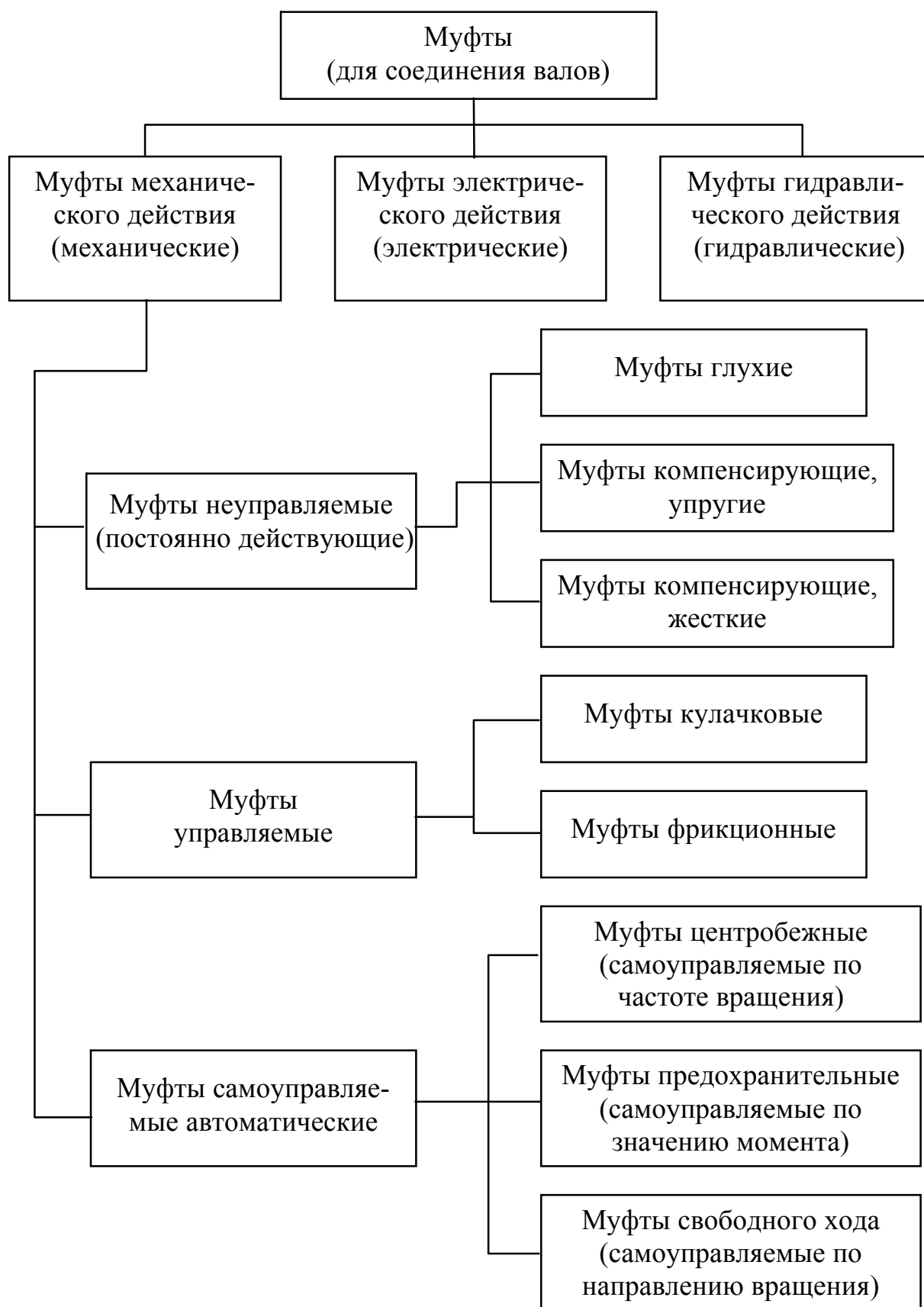
Рисунок 2.2 – Классификация муфт
