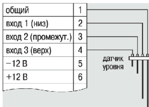
Рис. 13. Схема подключения кондуктометрических датчиков уровня
