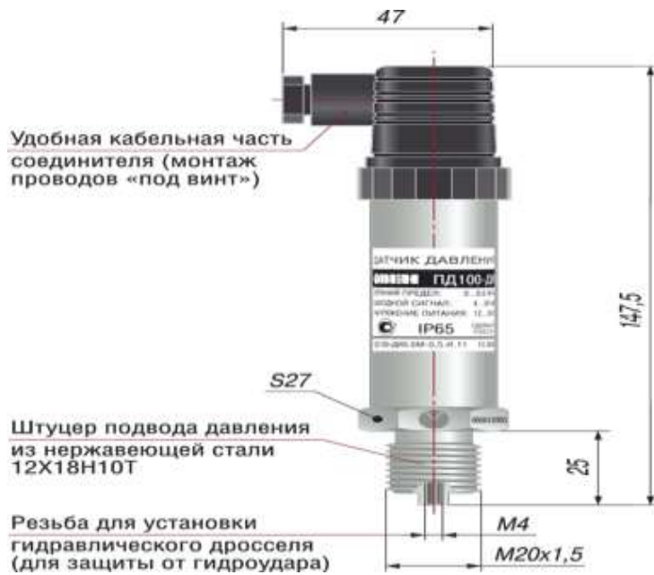
Рис. 1. Устройство ПД100
