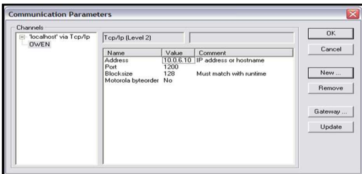
Рис. 20. Настройка коммуникационных параметров для соединения с ПЛК
