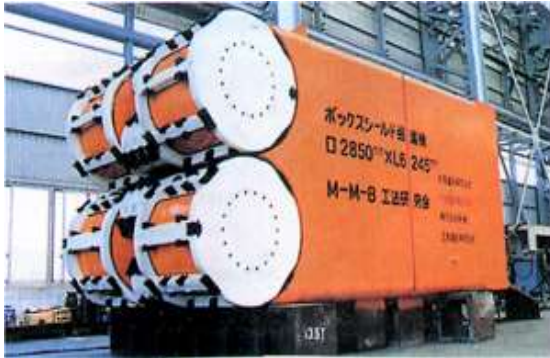
Рис. 2.6. Первый образец щита с рабочими органами барабанного типа
