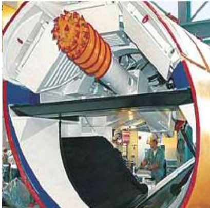
Рис. 2.9. Щит М-941М МHSM2 «Herrenknecht AG» d = 3,68 м
