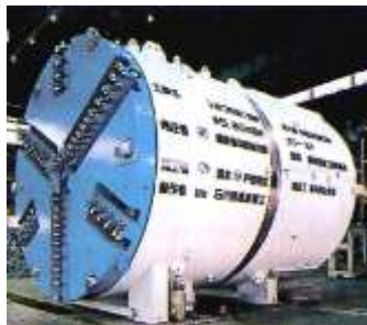
Рис. 3.2. Щитовая машина фирмы «Ишикавадзима-Харима» d = 5,8 м
