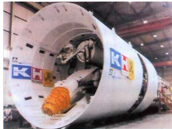
Рис. 2.12. Щит с воздушным пригрузом
