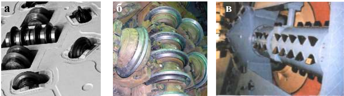
Рис. 5.3. Схемы расстановки рабочего инструмента: а, б – шарошки; в – резцы
