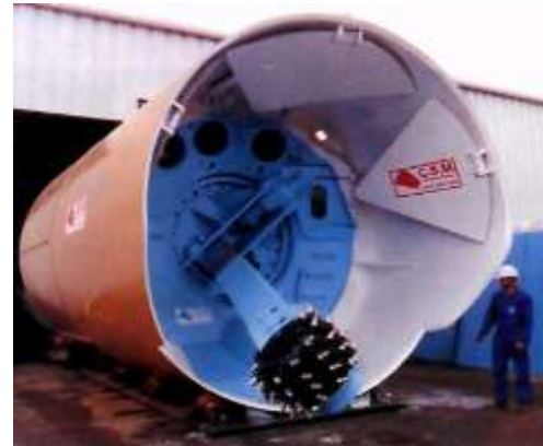
Рис. 2.10. Щит «CSM Bessac» d = 4,36 м
