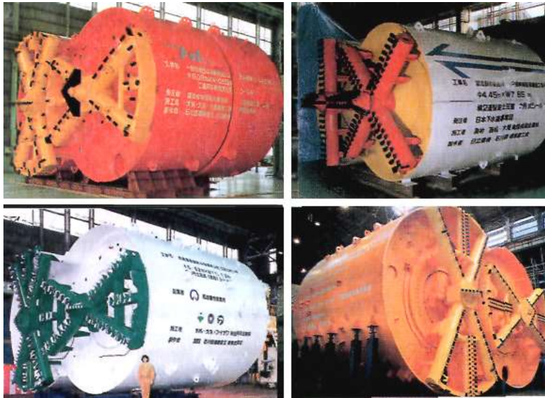
Рис. 3.6. Двухочковые щитовые машины горизонтальной ориентации, примененные при строительстве тоннелей в различных городах Японии
