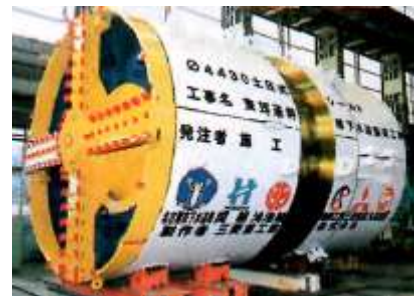
Рис. 3.3. Щитовая машина фирмы «Мицубиси» d = 4,45 м
