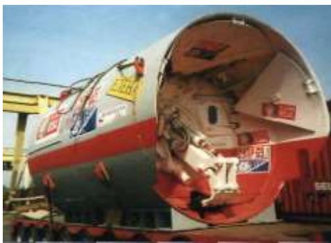
Рис. 2.15. Щит «CSM Bessac»
