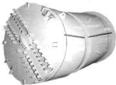
Рис. 3.1. Щитовая машина фирмы «Комацу» d = 2,89 м
