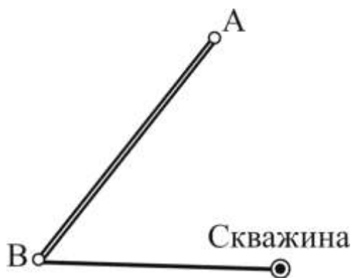
Рис. 4. Схема к перенесению скважины в натуру
