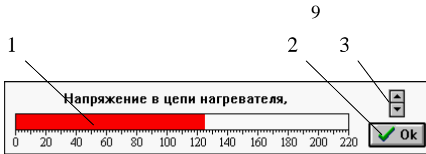
Рис. 5. Регулятор мощности нагревателя: 1 – шкала напряжения, 2 – кнопка выключения панели, 3 – регулятор напряжения
