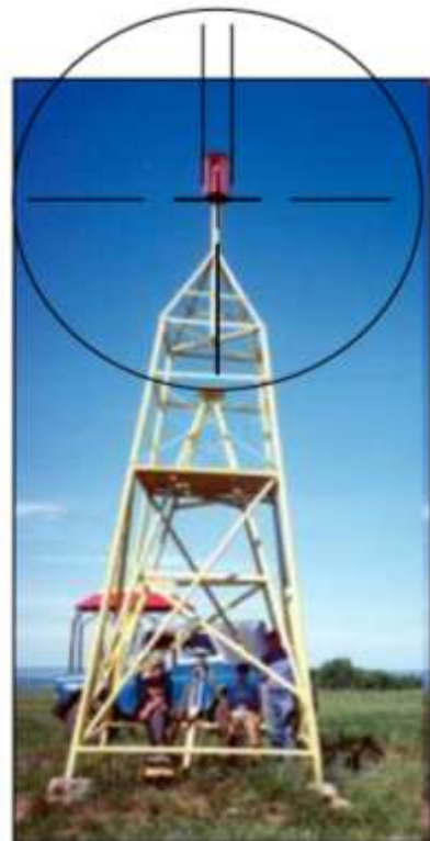
Рис. 16. Наведение сетки нитей на визирный цилиндр
