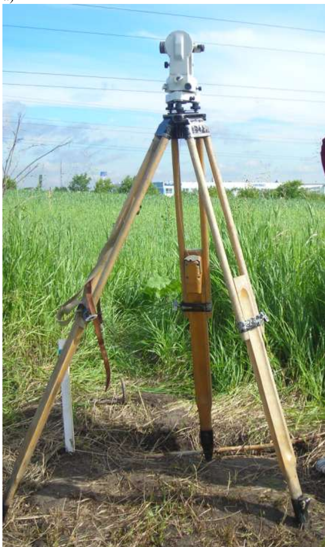
Рис. 12. а) Внешний вид теодолита 2Т30М на штативе; б) становой винт; в) груз нитяного отвеса
