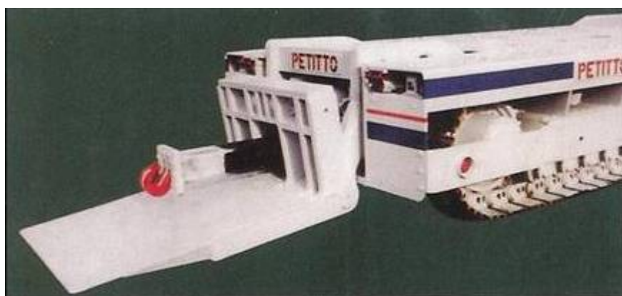
Рис. 2,б. Модель 3050, вид на платформу и втягиватель с крюком
