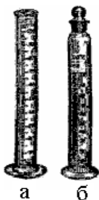
Рис. 13. Мерные цилиндры: а – обыкновенный; б – с притертой пробкой
