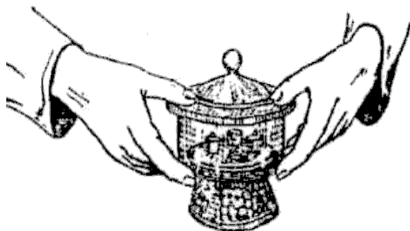
Рис. 7. Положение рук при переноске эксикатора
