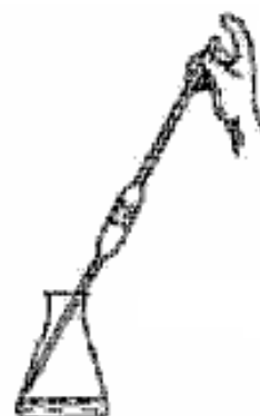
Рис. 16. Выливание раствора из пипетки
