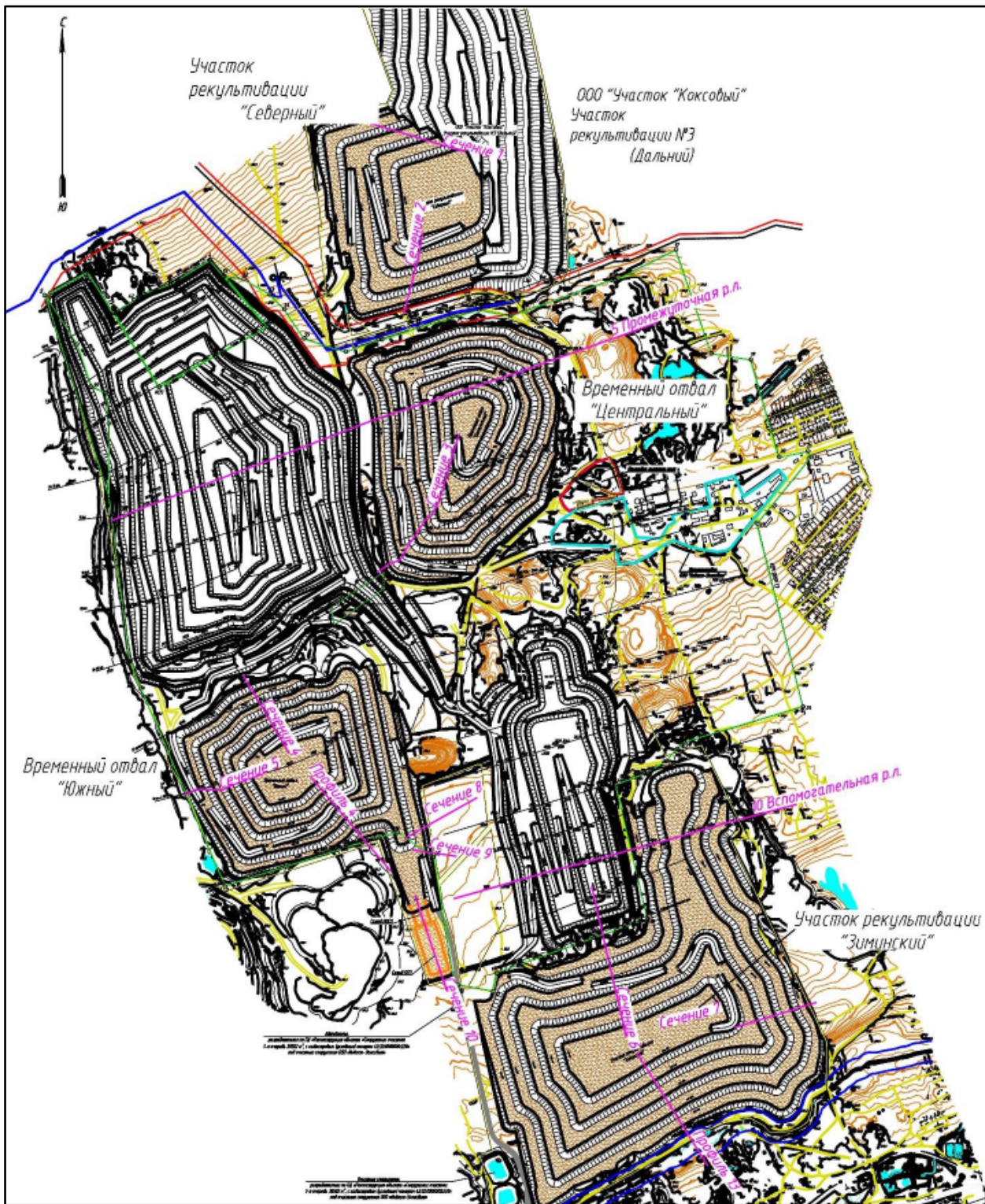
Рисунок 14.1 – Общий вид отвалов в конечном положении с расчетными сечениями для оценки устойчивости отвалов
