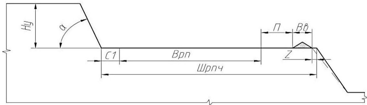
Рисунок 5.2 – Схема к определению ширины рабочей площадки при отработке четвертичных отложений (навалов)
