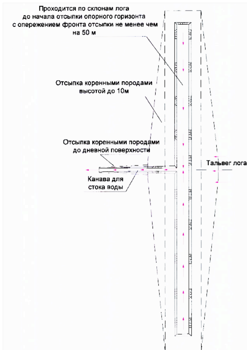
Рис. 2. Схема размещения водоотводной канавы в тальвеге лога
