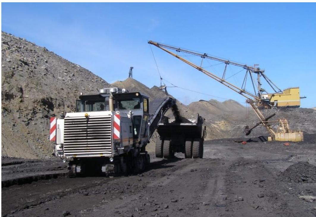
Рисунок 14.9 - Погрузка угля на автосамосвал грузоподъемностью 45 т. Отработка Третьего пласта. На переднем плане виден комбайн Wirtgen Surface Miner в процессе погрузки, на заднем - экскаватор мехлопата ЭКГ-5У и драглайн ЭШ-20/90
