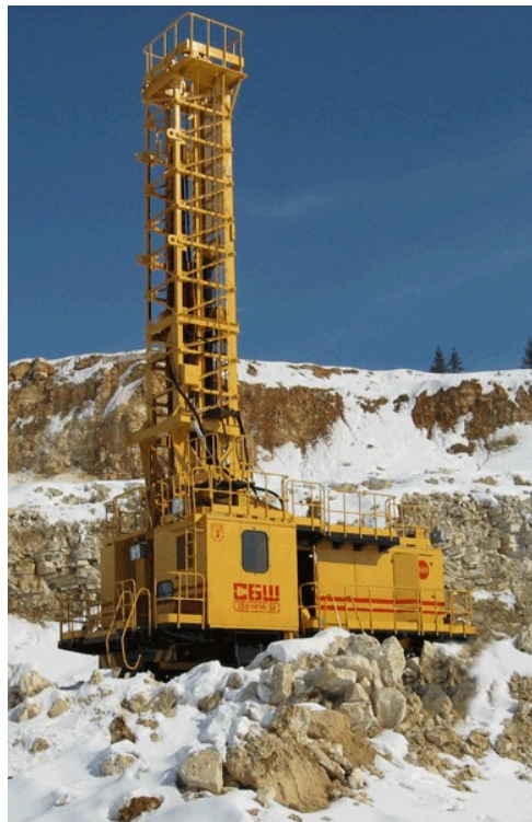
Рисунок 2.5 - Станок буровой шарошечный СБШ-250 МНА-32
