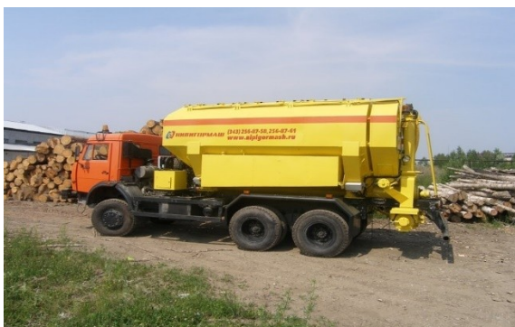
Рисунок 2.6 - Зарядная машина МЗ-3Б-12С
