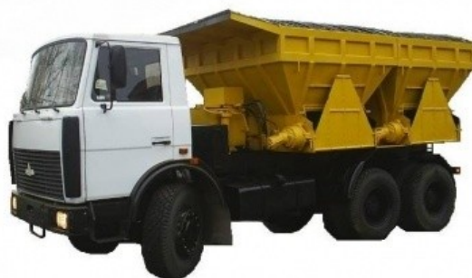
Рисунок 2.7 - Машина забоечная 3С-2М
