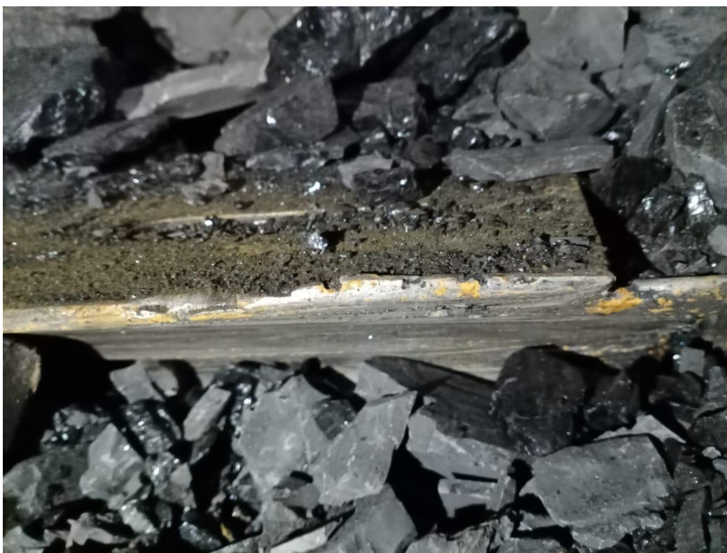
Рисунок 5.4 – Износ направляющей решетки с завальной стороны
