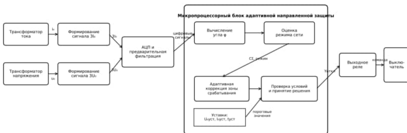
Рисунок 1. Структурная схема адаптивной направленной защиты от ОЗЗ
