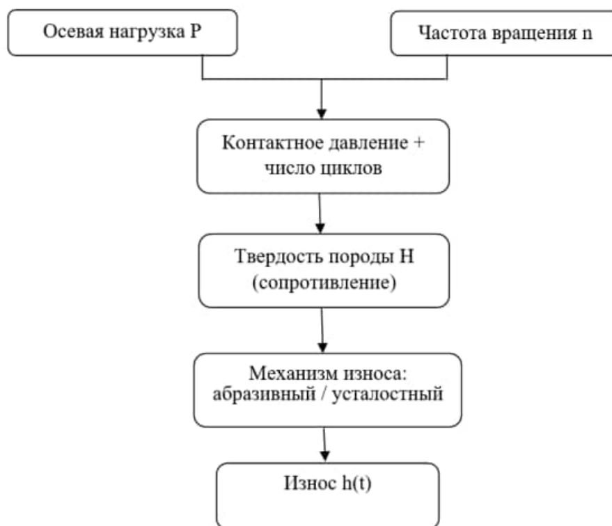
Рисунок 3. Схема основных факторов, влияющих на износ бурового инструмента
