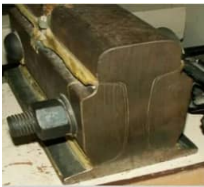
Рисунок 4. Клебоболтовой изолирующий стык
