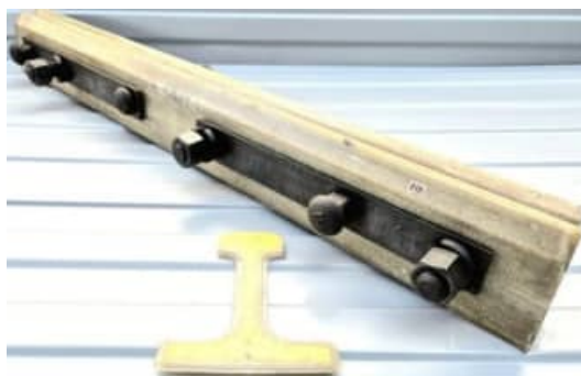
Рисунок 6. Бесстыковые изолирующие вставки
