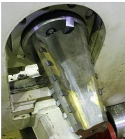
*Рисунок 17. Фреза с возможностью поперечного перемещения в законтурном канале*
