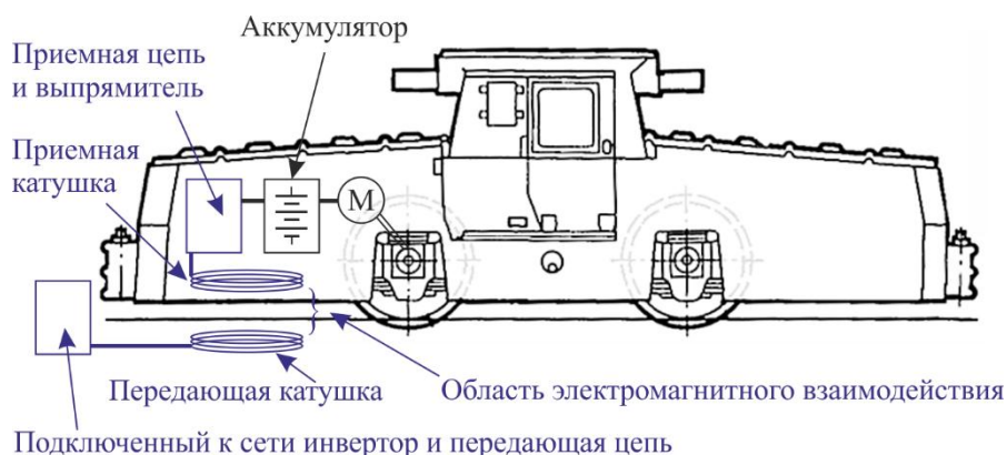
Рисунок 1. Увеличенная конструктивная схема системы беспроводного заряда аккумуляторов электровоза
