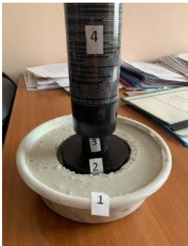
Рисунок 2. Изготовленное устройство для определения предела прочности на изгиб
