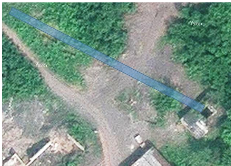
Рисунок 2 . Непогашенный вертикальный ствол и контур подземного вентиляционного канала (обнаружен георадиолокацией)
