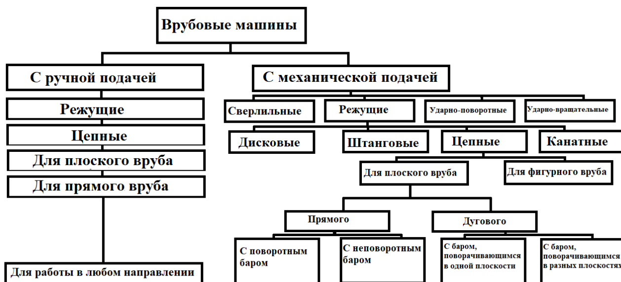
Рисунок 2. Классификация врубовых машин
